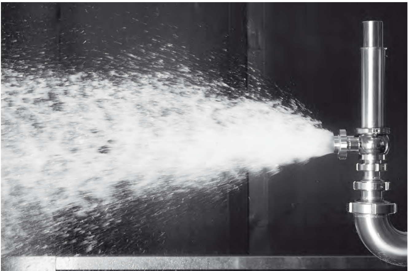
Sicherheitsventil im Guth Ventile Testcenter
